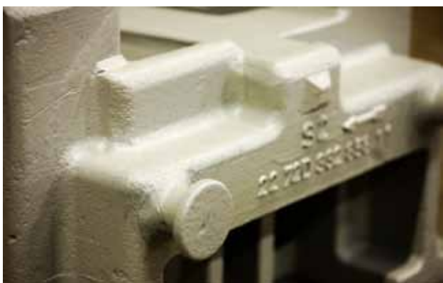
Удаляет остатки формочной смеси и литья из алюминия, композитов и т.д.
