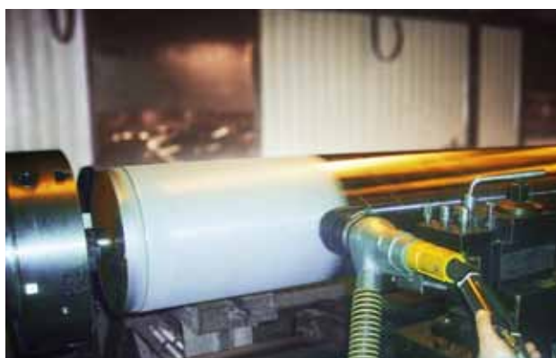
Удаляет лакокрасочные, резиновые, пластиковые покрытия на цилиндрических изделиях, что обеспечивает лучшее сцепление нового покрытия с поверхностью
