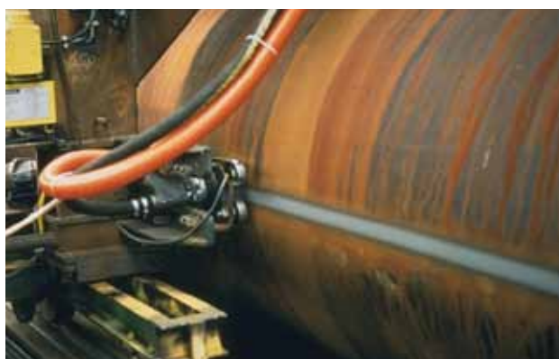
Эффективно очищает сварные соединения без необходимости использования шлифовальных инструментов
